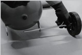
①割りピンを抜いて、タイヤ、スリーブ、シャフトを外します。タンク底面のドレンボルトを外します。
