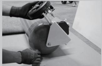
③ドレンボルトを軽く締め、シャフト、スリーブ、タイヤを取り付け後、ドレンボルトを締めてください。
