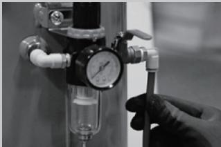
④EZ-40SX本体エアーレギュレーターのバルブ部分からエアーチャックのみを外し、付属の8mmウレタンホース付エルボフィッティングを取り付けます。
